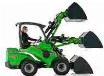
セルフレベリングシステムは、ブームの位置に関係なく、地面に対してアタッチメントの位置を同じく保ちます。セルフレベリングは油圧式で、ブームの左側にレベリングシリンダーがあり、パケットチルトシリンダーの動きに追従してアタッチメントを水平に保ちます。ブームフローティングのスイッチを入れると、セルフレベリングは無効になります。Avant 200 シリーズは、機械式ブームセルフレベリングを標準装備しています。チルトシリンダはアタッチメントカッピングプレートとリンクージロッドに接続されており、ブームの昇降時にアタッチメントを水平に保ちます。
